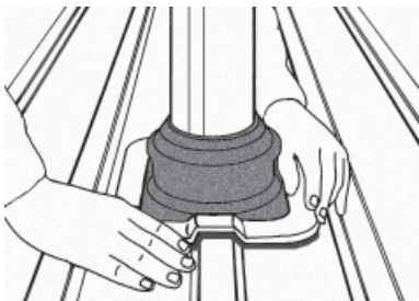
4. Dektite® formgenau an Profilblech anpassen
